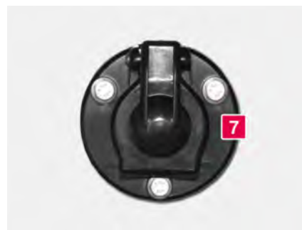
7 Gniazdo wtykowe do ładowania akumulatora 24V, 3-biegunowe
