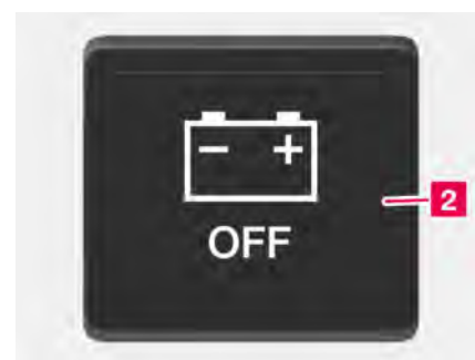
2 Przycisk elektrycznego głównego wyłącznika akumulatora
