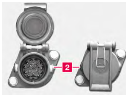
2 Gniazdo wtykowe oświetlenia 24V, 15-biegunowe
