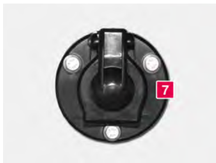
7 Gniazdo wtykowe do ładowania akumulatora 24V, 3-biegunowe
