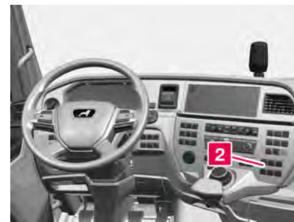
2 Przycisk elektrycznego głównego wyłącznika akumulatora
