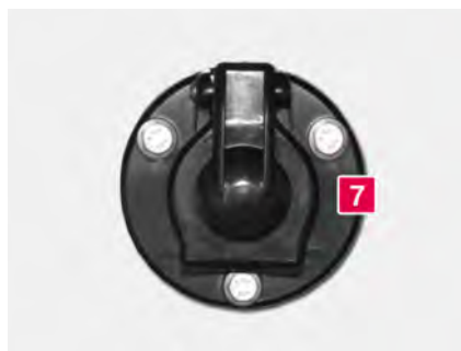
7 Gniazdo wtykowe do ładowania akumulatora 24V, 3-biegunowe
